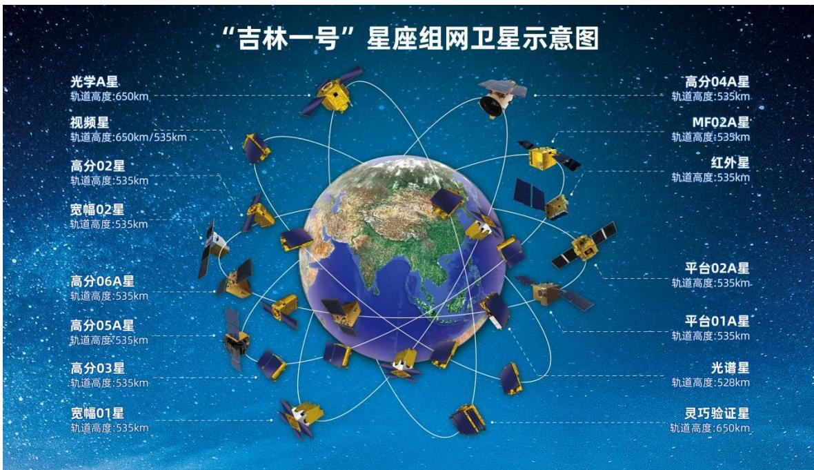
“吉林一号”星座是长光卫星技术股份有限公司在建的核心工程，一期工程由138颗涵盖视频、高分、宽幅、红外、多光谱等系列的高性能光学遥感卫星组成。截至目前，公司通过 22次成功发射实现108颗“吉林一号”卫星在轨运行，建成了目前全球最大的亚米级商业遥感卫星星座，在遥感信息服务上占据优势地位，并逐渐成为全球重要的航天遥感信息来源。以现有在轨卫星测算，“吉林一号”卫星星座可对全球任意地点实现每天 35~37 次重访，具备全球一年覆盖 3次、全国一年覆盖9次的能力，为国土安全、地理测绘、土地规划、农林生产、生态环保、智慧城市等各领域提供了高质量的遥感信息和产品服务，对数字中国建设具有重要意义。
